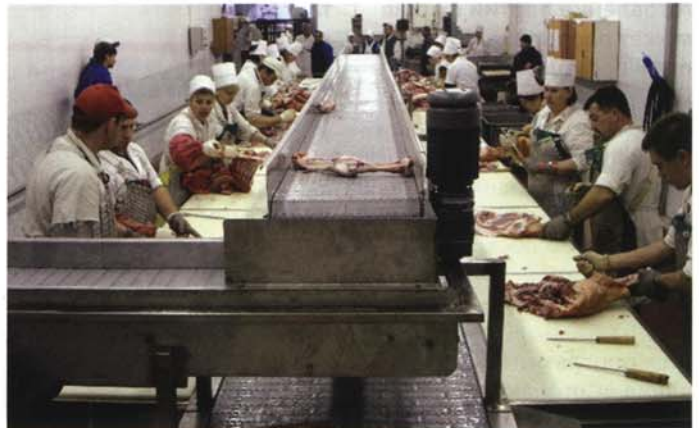
В двухъярусных конвейерах верхняя лента предназначена для транспортировки отрубов и костей, полученных после обвалки; нижняя лента служит для транспортировки жилованного мяса. Фото: «Липсия»
